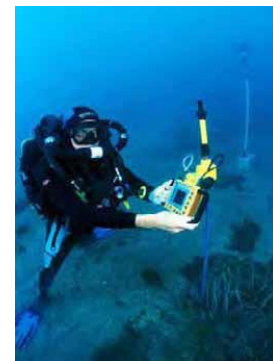
Figure 13 & 14 : Schéma du système de télémétrie acoustique alternative et plongeur équipé du pointeur mobile [17].
